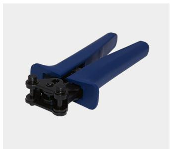
**Mechanisches Hand-Presswerkzeug mit austauschbaren Presskopfeinsätzen für verschiedene Kontakte und Leiterquerschnitte. Rücklaufsperrre zur Sicherung von vollständigen Verpressungen.**
